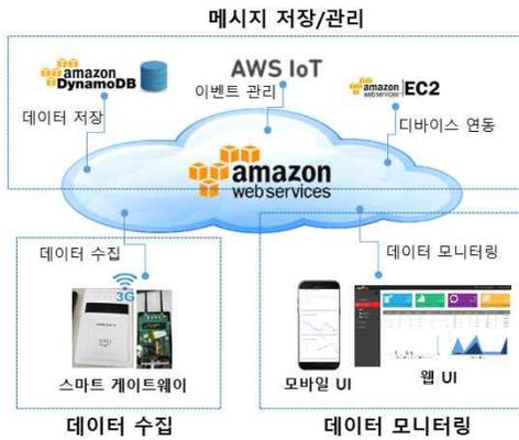
그림 1. 모니터링을 위한 시스템 구조
