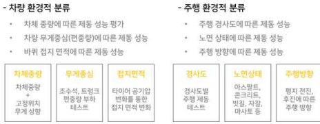
그림 1. 주행 환경 요소 정의 Fig. 1. Definition of driving environment elements
