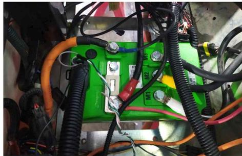
그림 4. MCU 실차장착 및 배선 연결
