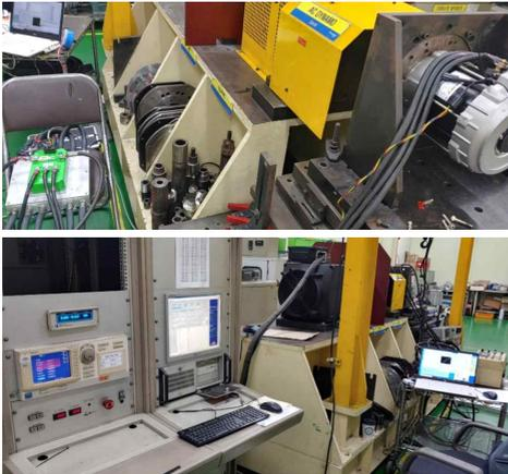
그림 1. 모터 및 MCU 다이نام로 시험
