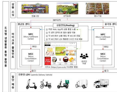
그림 1. 김천시 도입 예정인 도심형 마이크로 풀필먼트 개념도
