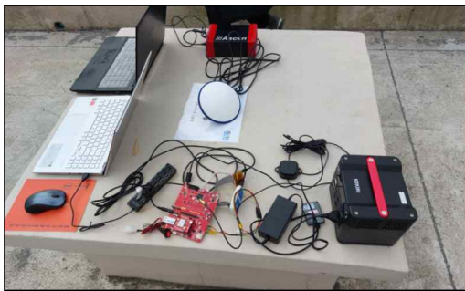
그림 9. GPS센서 정밀도 테스트 Fig. 9. GPS sensor precision test
